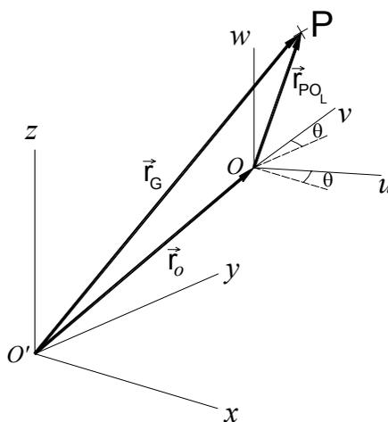
Figura 5 - Ponto  $P$  no Sistema Local com Translação da origem e rotação vertical.
