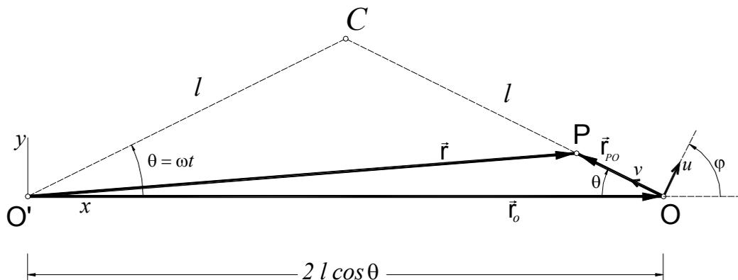
Figura 12 - Sistema Local tendo Rotação e Translação.
