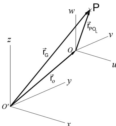
Figura 4 - Ponto P no Sistema Local que tem Translação Curvilínea.
