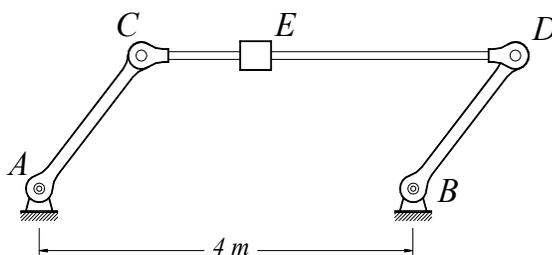
Figura 6 - Cilindro  $E$  deslocando-se na haste  $CD$ .
