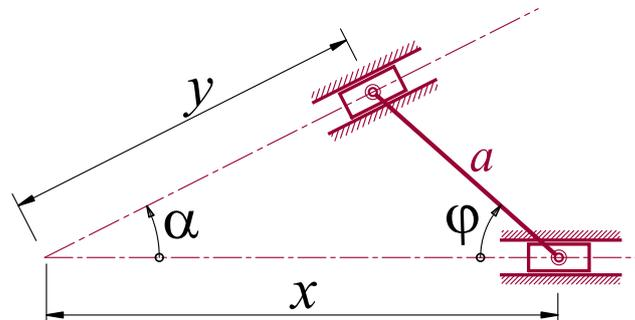
2. A cadeia mostrada tem dois graus de liberdade e os dois pistões deslizam em paralelo, o sistema tem  $(\alpha, x, \beta, y)$ , para coordenadas generalizadas. Verifique se os coeficientes da aceleração na coordenada  $\alpha$ , quando a barra  $a$  se tornar perpendicular à barra  $b$ , podem ser dados por:
