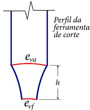
Perfil da fresa a ser construída.
