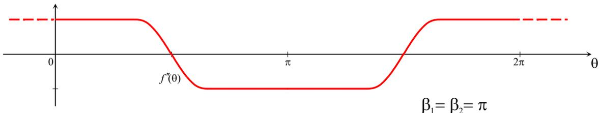
Em termos de qualidade, comparativamente à harmônica, temos aqui o valor 1,796 para a velocidade máxima e o valor 4,086 para a aceleração máxima, o que já nos permite afirmar que é bem melhor que a harmônica, levando em conta que a diferença na aceleração é muito maior em favor da função em estudo. Além do que, se compararmos as acelerações segundas máximas (apenas para o gráfico de composição das duas funções), vamos ter 15,5 para a harmônica em contrapartida com apenas 8,9, para esta função.
