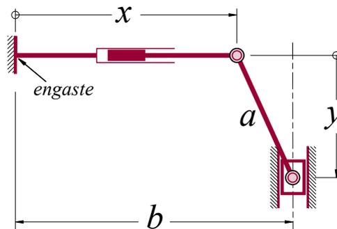
3. Ainda com base no problema anterior, considerando o ponto  $P$ , como ponto acoplador da barra  $a$ , estando este a uma distância  $d$  do centro da barra  $a$ , determine as equações paramétricas para o deslocamento, velocidade e aceleração do ponto  $P$  em função apenas das constantes envolvidas e das variáveis generalizadas que foram dadas.
