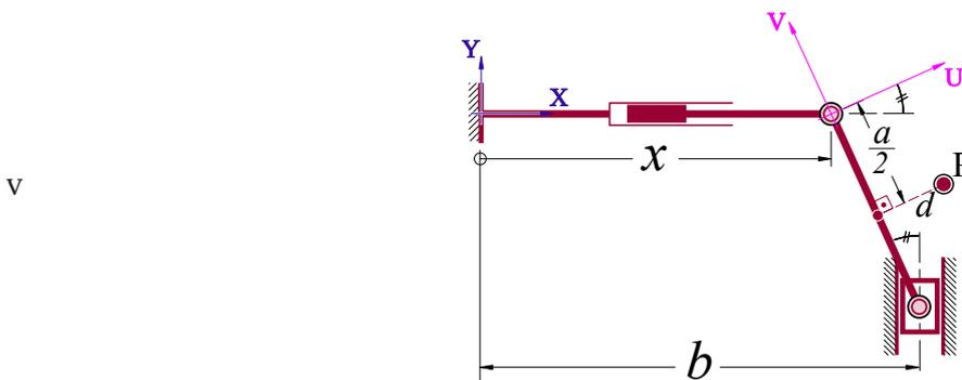
Desta forma, há de se notar que o ângulo formado pelo eixo  $U$  e a horizontal ( $s_i$ ) é o mesmo que a barra  $a$  forma com a vertical, desta forma
