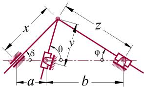
2. No mecanismo de plaina Stefhenson, o comprimento da barra *a* é constante e vai de par rotativo a par rotativo, também são constantes *b* e *r*. Determine o deslocamento, velocidade e aceleração do torpedo, considerando (y, x) para coordenadas generalizadas..
