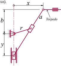
3. O mecanismo mostrado, onde a e b, a 90°, são uma única barra, tem o sistema (y, x) para coordenadas generalizadas. Determine o deslocamento, velocidade e aceleração para o ponto  $\bf P$  do acoplador. Perceba, no entanto, que a variável  $\phi$  não faz parte do sistema de coordenadas generalizadas e não deve constar nas expressões finais.
